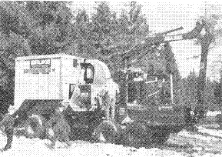
Svéd gyártmányú, önjáró aprítógép
